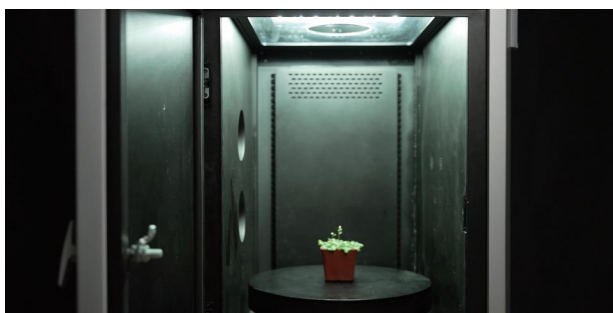
顶端CCD相机和升降台双向对焦
